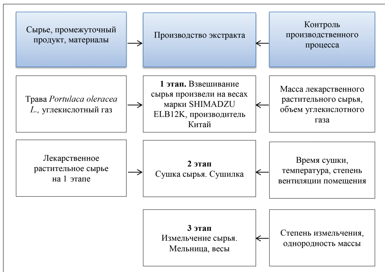
Рисунок 1 – Технологическая схема производства углекислотного экстракта Portulaca oleracea L.
